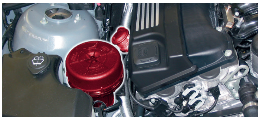
Válvula de aire secundario y bomba de aire secundario en el BMW E46 (destacado)
