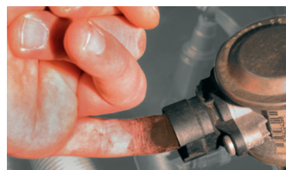
"Prueba dactilar" en la válvula de aire secundario en el BMW 520i (destacada) Si en este lado hay sedimentaciones, la válvula de retención no es estanca y tiene que cambiarse.
