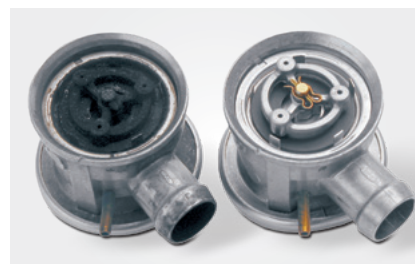
Válvula de aire secundario abierta A la izquierda: Daños por condensado de gases de escape Derecho: En estado nuevo
